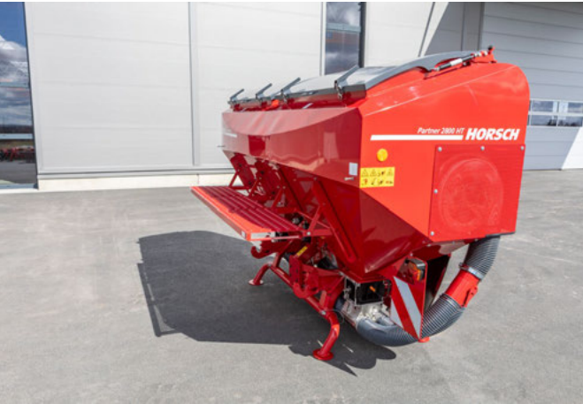
Sistema de tanque duplo com capacidade de 2 800 l
