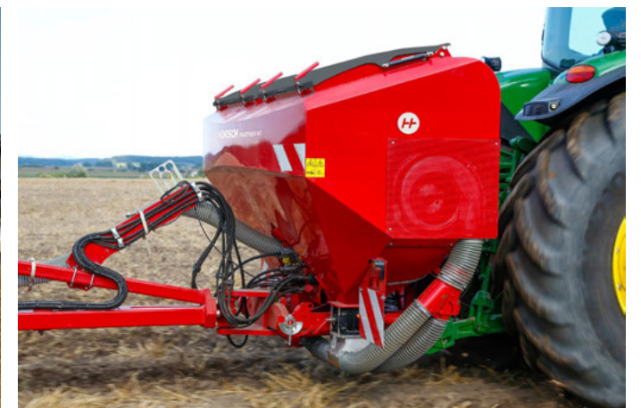
Tanque duplo com capacidade de 2 800 l
