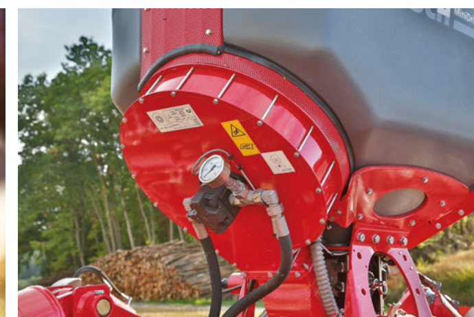
Possui turbina própria
