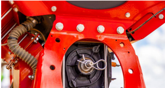
Sistema de dosagem com dosador elétrico de alta performance
