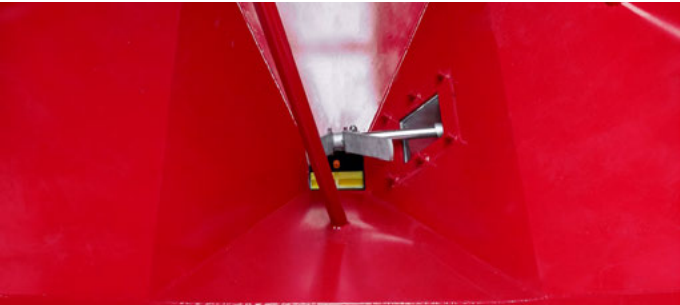
Reservatório de fertilizante com eixo agitador
