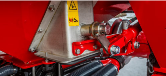
Eixo agitador de fertilizante fora do tanque
