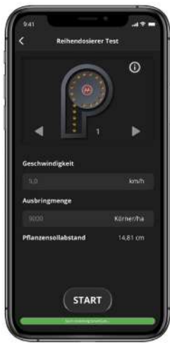
Por meio do aplicativo HORSCH Control, teste dos parâmetros mais importantes da qualidade de singulação pode ser realizado a qualquer momento
