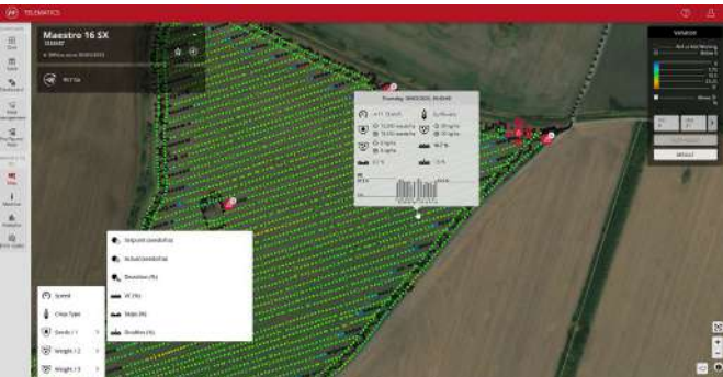
Fator de sucesso transparência: dados específicos da posição de todas as informações relevantes, como mensagens de erro, velocidade operacional ou qualidade de singulação
