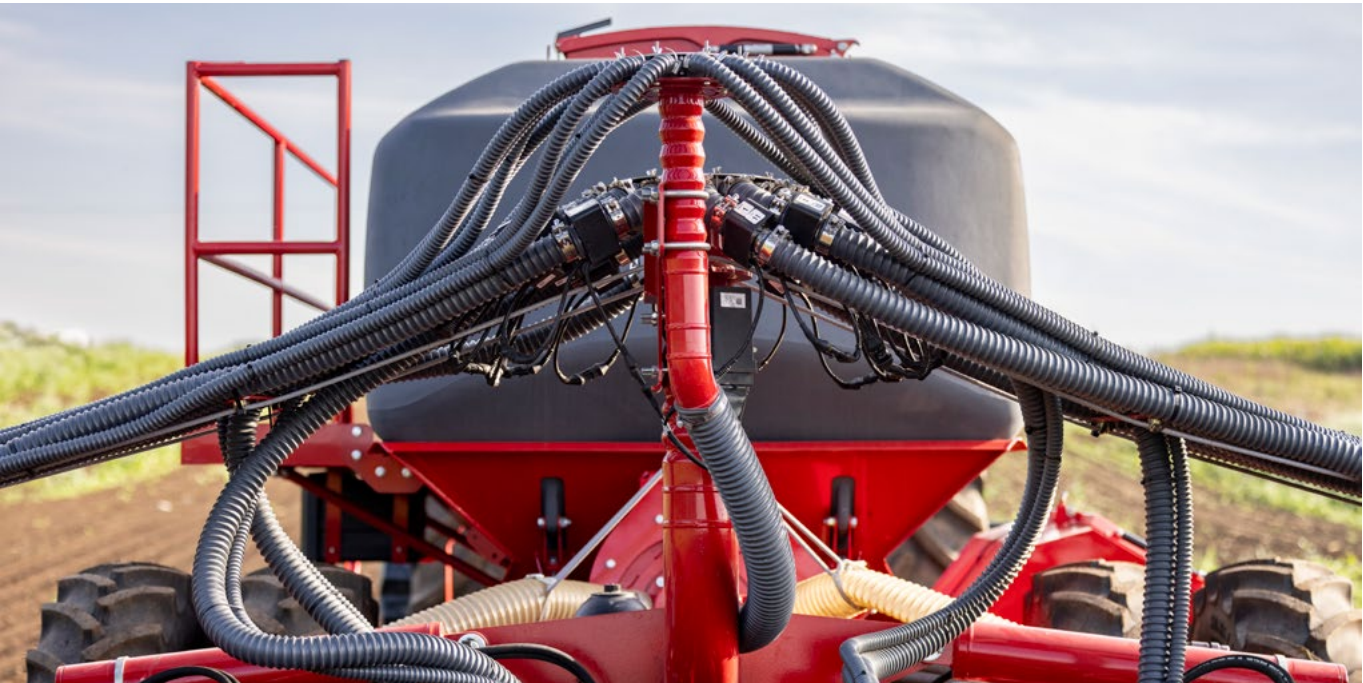
Torres de distribuição de fertilizantes e microgranulados e mangueiras de distribuição
