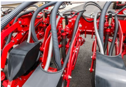
Sistema pantográfico com pressão hidráulica na linha de plantio
