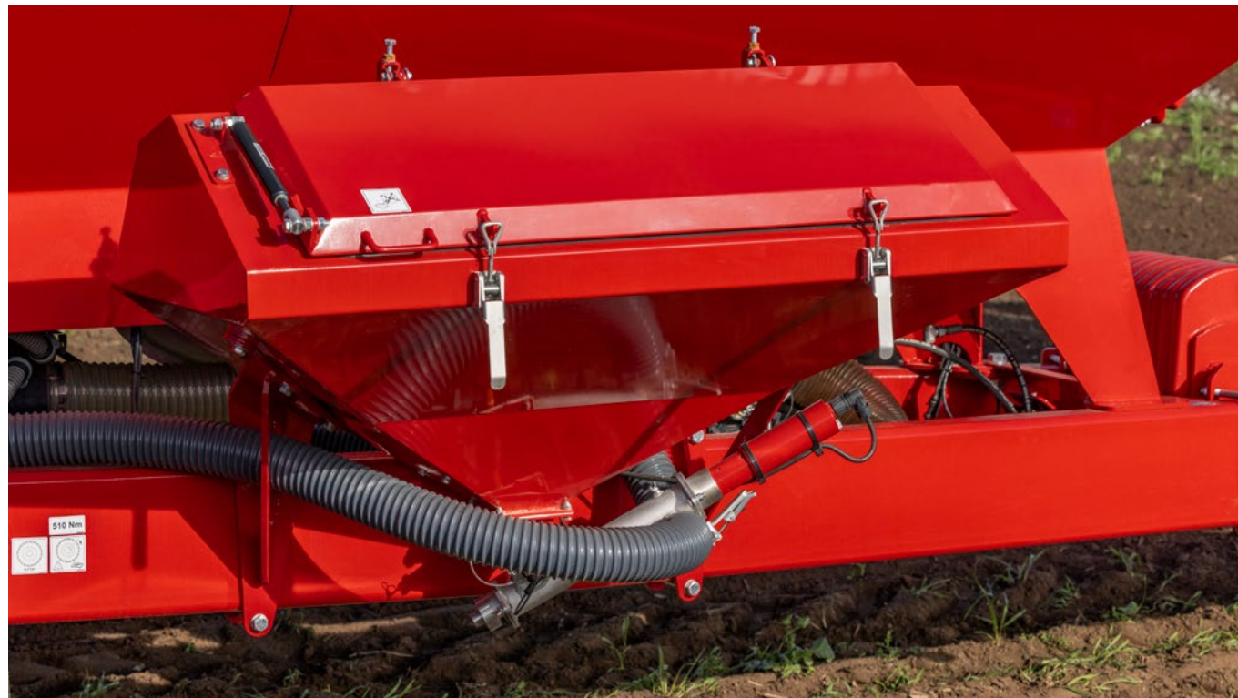
Caixa microgranuladora para plantio consorciado ou aplicações de outros insumos
