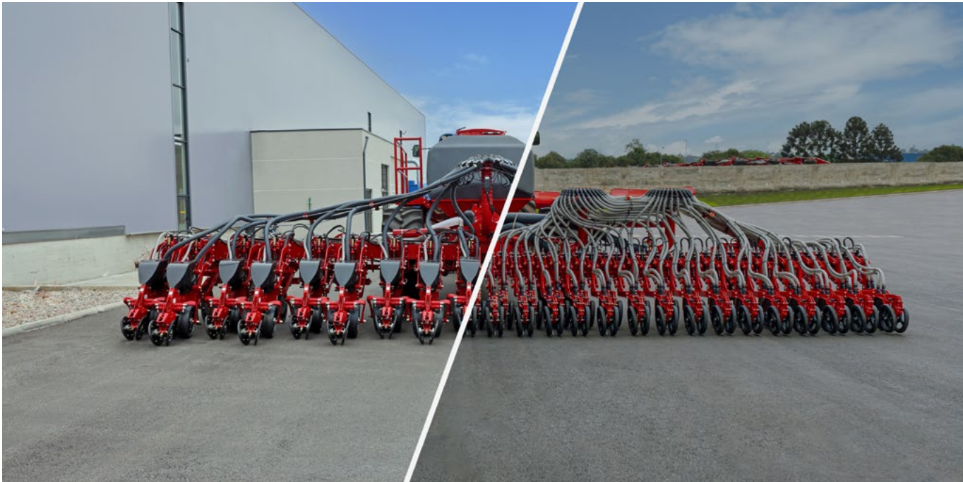
Possui barra intercambiável, planta culturas de verão e inverno
