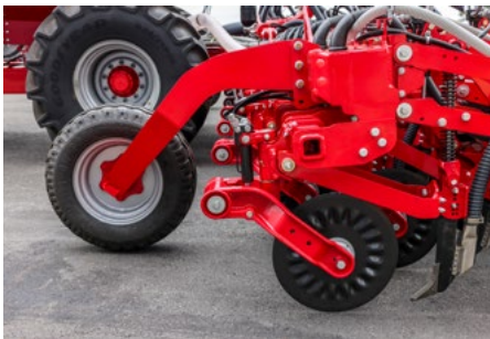
Linha de plantio com pressão hidráulica no corte independente
