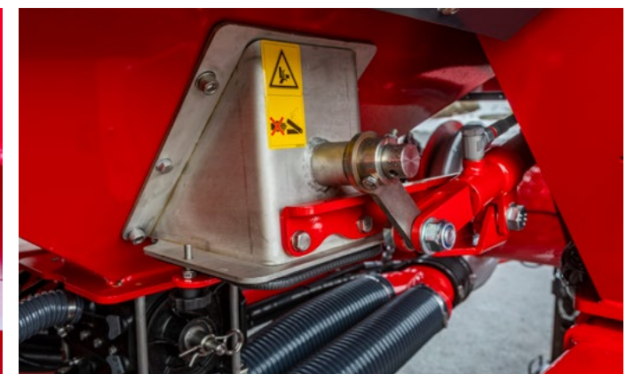
Eixo agitador de fertilizante fora do tanque
