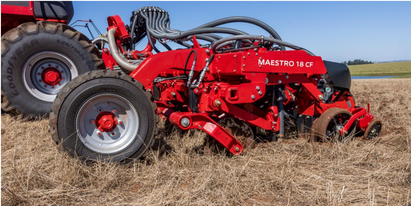
Linha de plantio com pressão hidráulica no corte e pantógrafo
