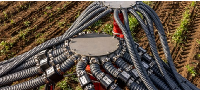
Torre de distribuição de fertilizante e microgranulados
