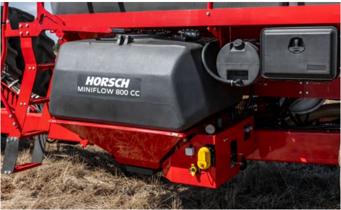
MiniFlow 800 CC com tanque para retrolavagem
