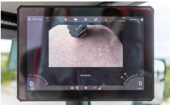
Visualização de dentro da cabine dos rodados, para evitar ao máximo as perdas por amassamento
