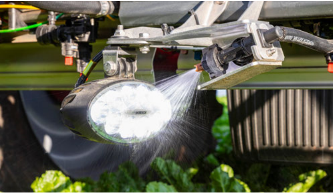
Sistema de iluminação das barras com limpeza automática
