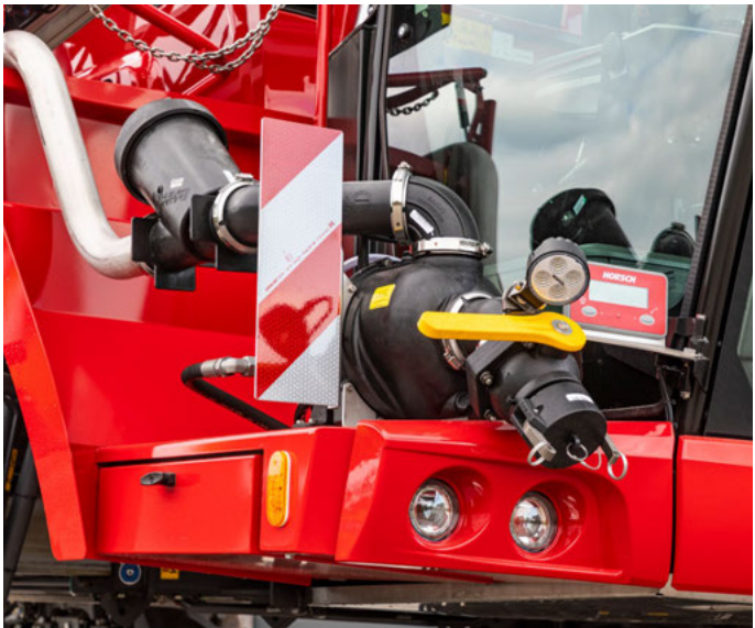
Bomba frontal de abastecimento com recalque de 1.000 l/min
