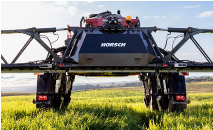
Bitola máxima de 3,50 m, aprimorando o equilíbrio durante a operação
