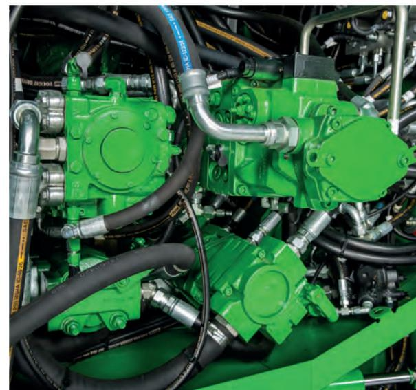
A transmissão hidrostática é acionada por duas bombas de pistão, fornecendo velocidade variável. Para máquinas com rodas, cada roda de acionamento possui seu próprio motor de pistão de deslocamento variável, possibilitando atingir uma velocidade máxima de 24,6 km/h. As máquinas de esteira possuem um motor de pistão de deslocamento fixo por esteira e podem atingir até 9 km/h.
