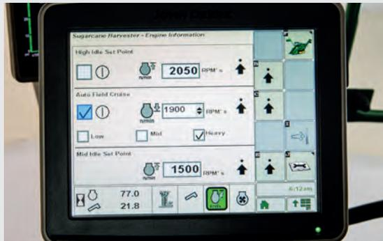
Definições de controle de rotação do motor
