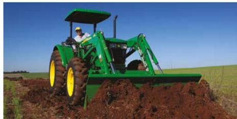
Nivelar o terreno, ou empurrar materiais ficou muito mais fácil com a Lâmina Frontal GreenSystem™ AF2196G. Com 2,4 m de largura, permite que grande volume de material seja deslocado.
