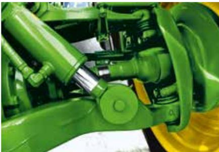
Detalhe do eixo com suspensão
