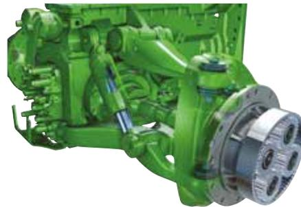
Eixo dianteiro com suspensão
